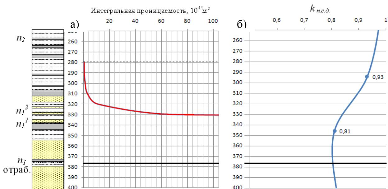
Рис. 1 – Изменение интегральной проницаемости (а) и коэффициента понижения статического давления (б) с глубиной для песчаников нарушенного углепородного массива над отработанным пластом  $n_1$  в районе скважины №3431 пробуренной на поле шахты им. А.Ф. Засядько
